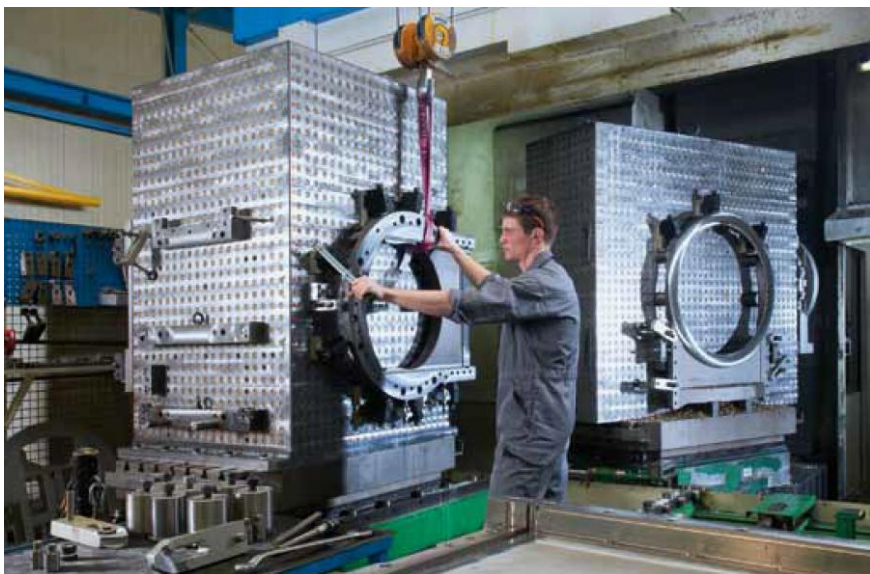
Corpo valvola di grandi dimensioni durante la lavorazione su macchina automatica
